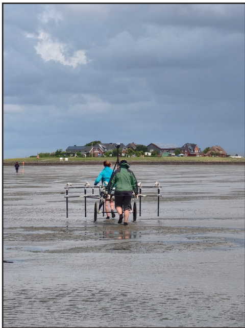
Abb. 3: Geophysikalische Prospektion mit dem Magnetikwagen auf Hallig Hooge während der TORF-Kampagne, Juni 2026 (Foto: Dennis Wilken).
