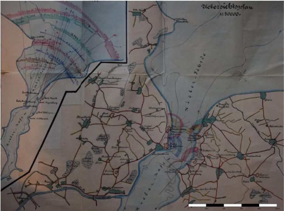
Abb. 4: Plan der Befestigungen des Kieler Kriegshafens unter der Berücksichtigung der jeweiligen Bestreichungswinkel und Geschützreichweiten, etwa um 1900 (Archiv Deutscher Marinebund Laboe)
